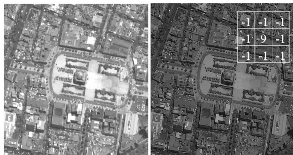
Figura 2. Izquierda, imagen pancromática sin ningún proceso de realce geométrico; derecha, imagen pancromática realizada con filtros de convolución.
