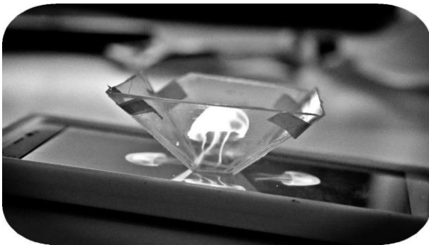
Figura 1. Proceso de elaboración de la pirámide invertida. En primer plano, se observa un celular con la pirámide invertida. Hardware utilizado: celular, pirámide, en software archivo multimedia ( http://www.taringa.net/post/hazlo-tu-mismo/18835572/Convierte-tu-Celular-en-un-Proyector-de-Hologramas-3D.html ).
