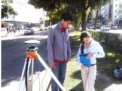
Figura2. Medición en campo de puntos de apoyo terrestre, empleando receptor de GPS
